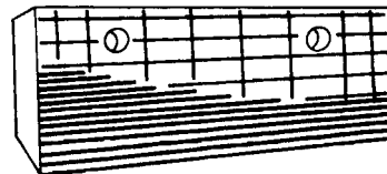
Final trépanos de niveladoras
