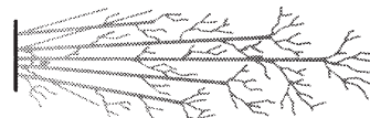
Fundición gris: Rayos inicialmente rojos, que más adelante se vuelven amarillos. Con muchas chispas, longitud 0,6m.
